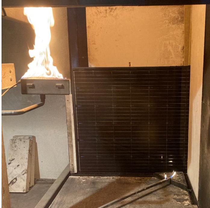
Abbildung 6: Modul während des Tests zur Bestimmung der Brandschutzklasse
